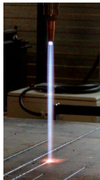
Сильный поток кислородной резки из дивергентного сопла. Фото взято из KOIKE тестирования. Тип сопла 106-D7N o 0. Над листом от сопла 275 мм
