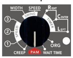
Предварительная настройки может записывать 3 скорости. Легкая регулировка скорости и параметров для газокислородной, плазменной резки и сварки.
